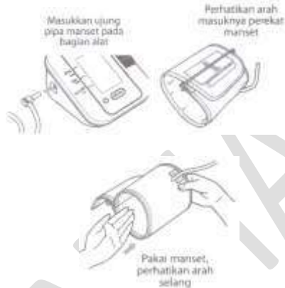
Gambar 6. Cara Pemasangan Manset Pada Tensimeter Digital
